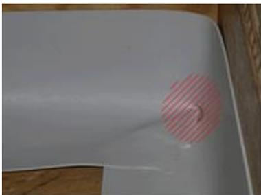
17. Poncer la surface à souder (correspond à la rondelle formée) dans l'angle avec du papier abrasif /Scotch Brite.
