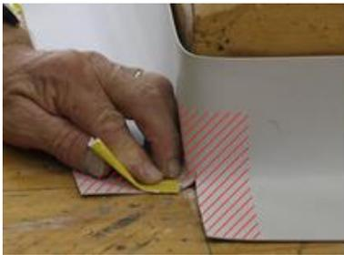
8. Poncer la surface à souder vers l'angle au moyen d'un papier abrasif/ Scotch Brite.
