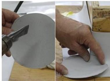
9. Chauffer et former la rondelle à l'aide d'un föhn à air chaud ...
