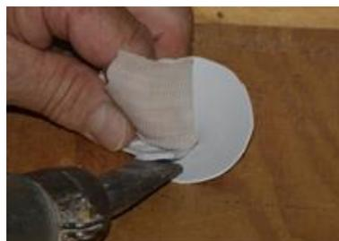
16. Chauffer l'angle à l'aide d'un föhn à air chaud, compresser à la main et souder.
