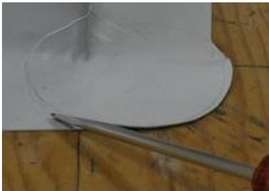
14. Les cordons de soudure peuvent être testés à l'aide d'un tournevis après refroidissement.
