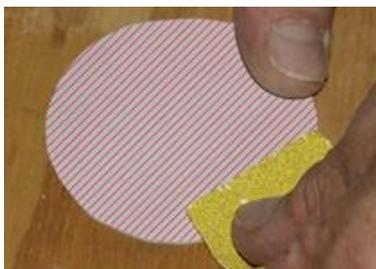
12. Poncer l'envers de la rondelle au moyen d'un papier abrasif/Scotch Brite.
