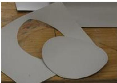
5. Découper une rondelle dans un morceau de bande utilisée.
