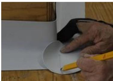
6. Placer la rondelle dans le coin et dessiner la surface à souder.
