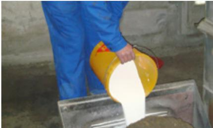
*Fig. 19: Dosage de Sika® ColorCrete-G sur le tapis roulant*
