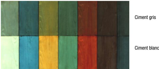
Fig. 12: Influence de la couleur du ciment sur la couleur du béton
