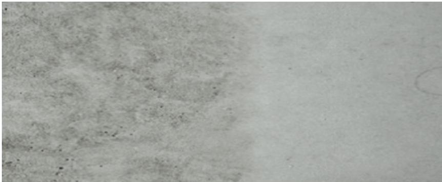
Fig. 9: Conséquences d'une application en trop grande quantité (à gauche) et quantité adéquate (à droite)
