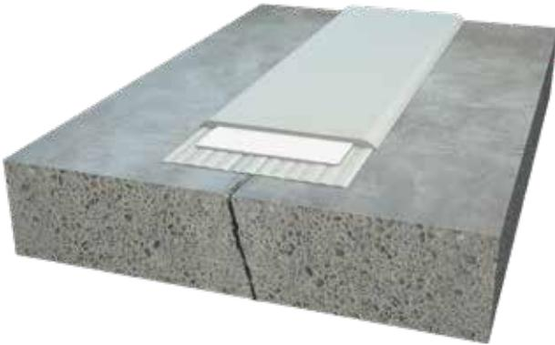
Pour les joints de reprise ou les fissures fines, la bande Sikadur Combiflex® SG est surcouchée complètement avec la colle Sikadur® Adhésif à base de résine époxy. En fonction des exigences, la colle peut être lissée, saupoudrée de sable de quartz ou revêtue. Les fissures de > 1 mm doivent être traitées comme les joints de dilatation.
