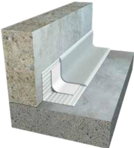
Il est recommandé d'exécuter les raccords sols/parois à l'intérieur comme des gorges. La colle Sikadur® à base de résine époxy sous la bande peut être formée en conséquence. Lors d'un montage comme étanchéité négative, la pression d'eau est limitée à 0.5 bar.
