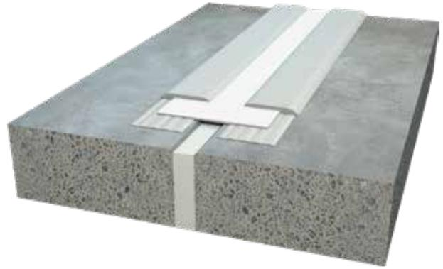
Pour les joints de dilatation ou les grandes fissures, mettre en place la bande Sikadur-Combiflex® SG dans la zone de mouvement sans colle à base de résine époxy. La zone de la bande non collée est déterminante pour l'amplitude du mouvement. En cas de grands mouvements, former une boucle avec la bande lors de la pose.
