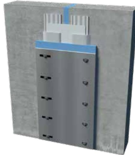
Pour les joints exposés à une pression d'eau négative supérieure à 0.5 bar, la bande Sikadur-Combiflex® SG doit être assurée sur un côté à l'aide d'un profilé métallique.
