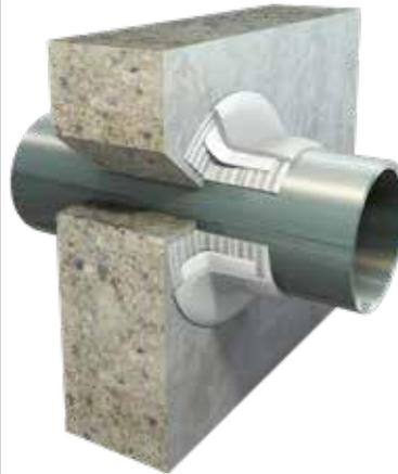
Les pénétrations de tuyaux peuvent en général être exécutées avec la colle Sikadur® à base de résine époxy. En fonction du matériau du tuyau, il faut utiliser un primaire correspondant ou une colle adaptée, le cas échéant, utiliser des colliers de serrage supplémentaires.
