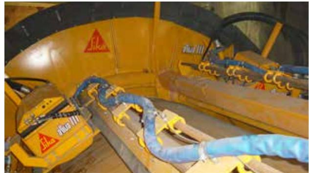
Projection de consolidation derrière l'excavation avec un béton projeté par voie humide à l'avancement du tunnelier
